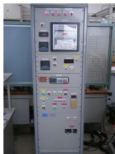
図 3-10 ダイナミックヒーティング試験機外観及び熱気流操作パネル 写真
