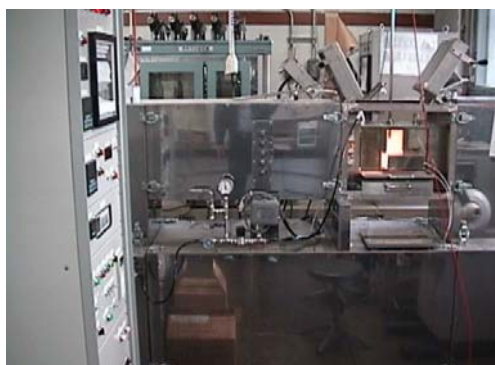
図 3-10 ダイナミックヒーティング試験機外観及び熱気流操作パネル 写真
