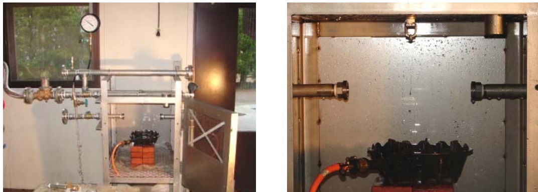
図3-2 ロジメント試験装置 写真
